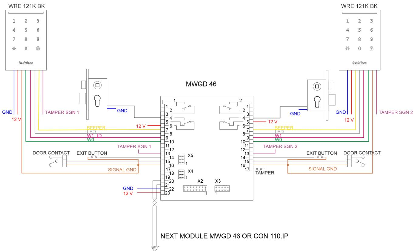
**Schéma zapojení 1:** Zapojení dvou čteček WRE 121K a duálního dveřního kontroléru MWGD 46 pro kontrolu dvou dveří. Každé dveře mají zároveň dveřní kontakt i odchozí tlačítko. Hnědý vodič čtečky (0V) je galvanicky spojen s modrým vodičem. Pokud neřešíme problém s rozdílnými zemnícími potenciály, můžeme použít modrý vodič i pro dveřní kontakt nebo odchozí tlačítko. Naopak hnědý vodič nikdy nepoužíváme pro napájení.
