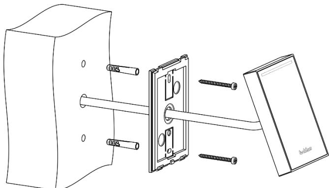
**Montáž na zed:** pomocí dvou hmoždinek a vrutů 3,5 x 4 mm se uchytí zadní kryt, a poté zacvakne čtečka.
