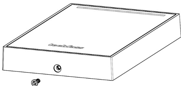
**Pojistný šroubek:** Po zacvaknutí čtečky do zadního krytu se spojení pojistí šroubkem.
