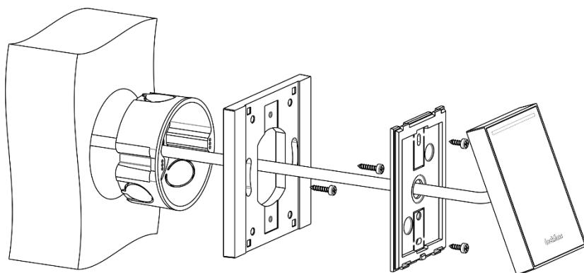
**Montáž na instalační krabici KU 68:** Na instalační krabici KU 68 přišroubujeme nejprve plastový adaptér, a poté uchytíme zadní kryt na adaptér. Kratší vrutky pro montáž zadního krytu jsou součástí balení adaptéra.
