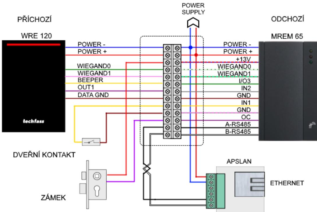
*Schéma zapojení 2: Jednodušší varianta z pohledu kabeláže.*
